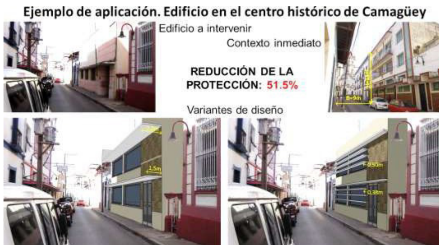
Fig. 4. Ejemplo de aplicación de la herramienta al diseño de la protección solar de un edificio en el centro histórico de Camagüey. Elaborado por Guillermo A. De la Paz.
