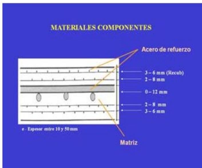
Figura 1: Materiales componentes del ferrocemento.
