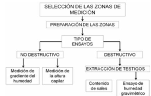
Figura 6: Esquema experimental de los ensayos patológicos.
