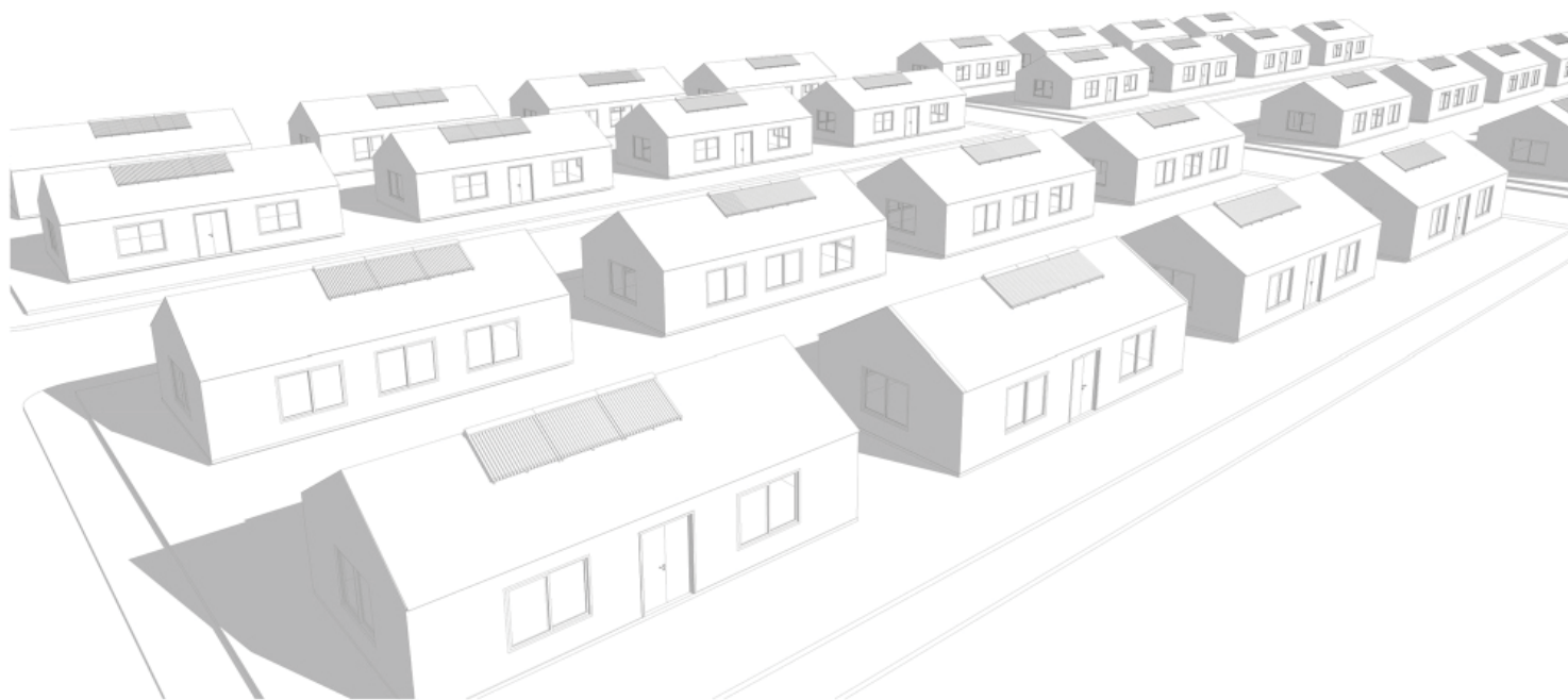
Figura 13: Conjunto de viviendas con sistema de colectores dimensionados e integrados en Archicad y Ecodesigner. (Los Autores)
