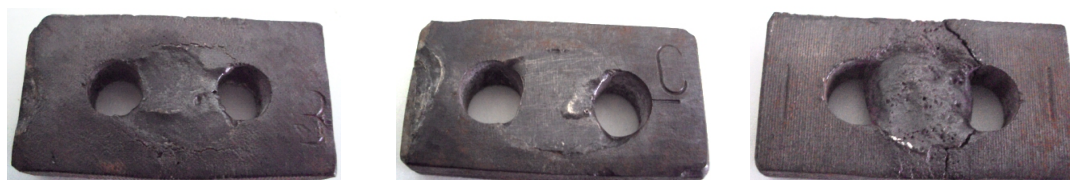
Figura 4. Probetas sometidas a ensayos de fatiga térmica. Fuente: Autores
