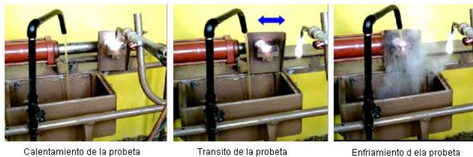
Figura 3. Secuencia del ensayo de fatiga térmica. Fuente: Autores
