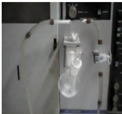
**Figura 1.** Sistema utilizado en la determinación de Hg
