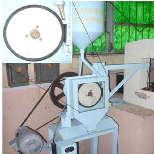
**Figura 3.** Máquina utilizada para el ensayo de la resistencia al desgaste abrasivo de acuerdo a ASTM G65 (Rodríguez y col., 2019)
