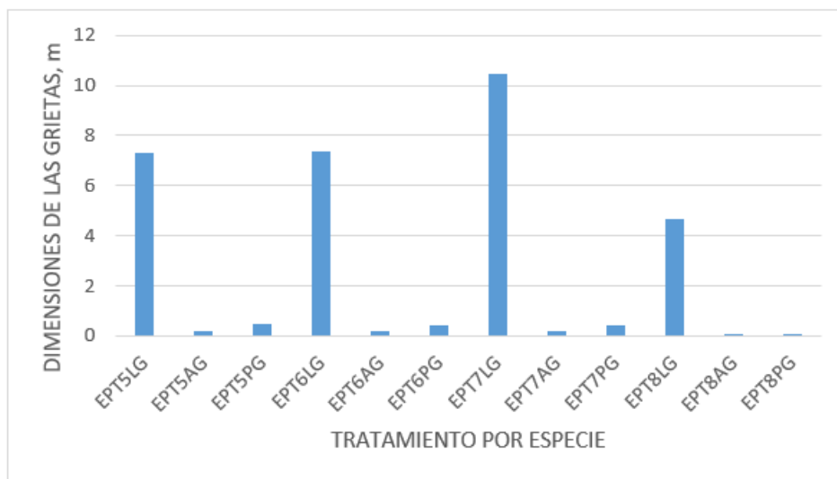
Figura 4. - Dimensiones de las grietas por tratamiento en Eucalyptus pellita . T5-Tratamiento 5, T6-Tratamiento 6, T7-Tratamiento 7, T8-Tratamiento 8, LG- Longitud de las grietas, AG-Ancho de las grietas, PG-Profundidad de las grietas
