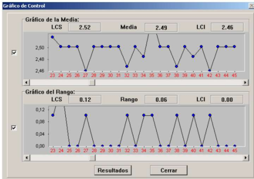
Fig. 2. - Exposición gráfica de la variación de aserrado para piezas de 3 m de longitud
