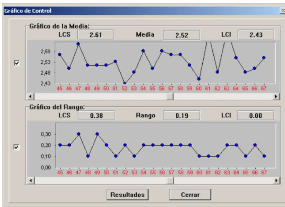
Fig. 3. - Exposición gráfica de la variación de aserrado para piezas de 4 m de longitud
