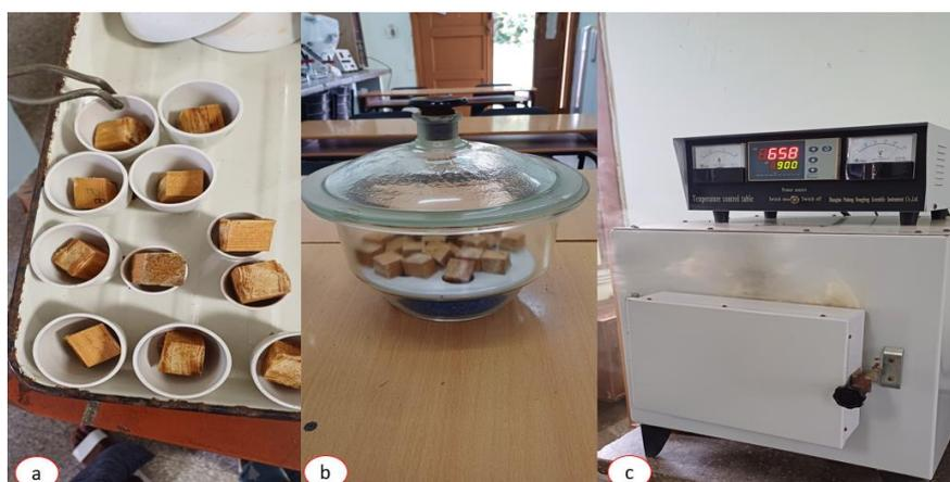
**Figura 3.** - *Materiales y equipos de laboratorio. a- crisoles, b- desecador, c-mufla*
