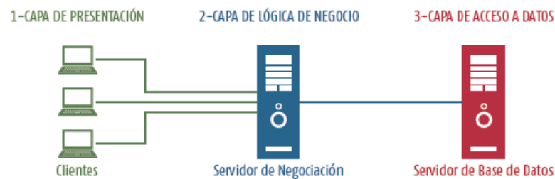
Figura 1. Arquitectura en 3 capas.
