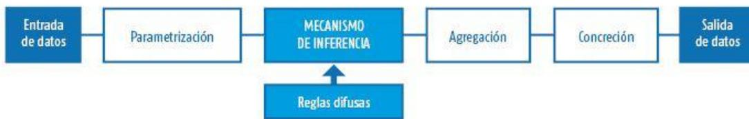
**Figura 2.** Diagrama de bloques de un control difuso
