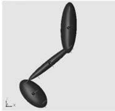
Fig. 5 Modelo de la pierna según el abordaje del péndulo doble generado por el SimMechanics
