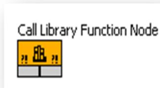
**Figura 2. Función de LabVIEW para utilizar DLLs.**
