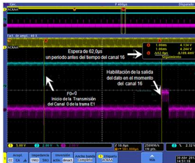
Fig.9 Implementación del Subsistema de Temporización.
