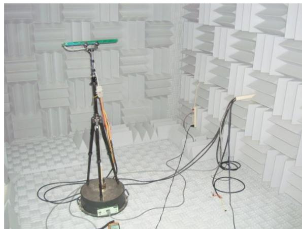
**Figura. 4 Arreglo de micrófonos sobre la mesa giratoria en el interior de la cámara acústica semi-anecoica.**
