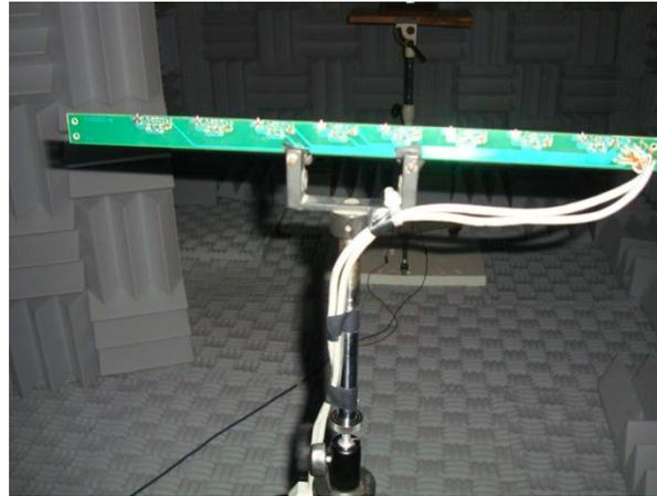
**Figura. 2** Arreglo lineal uniforme de 8 micrófonos tipo electret, separados a una distancia de 4cm entre sí.
