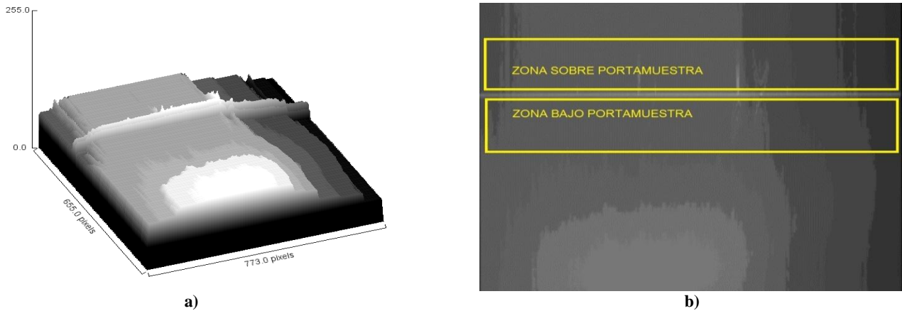
Figura 7. a) Distribución de la iluminación (en tonos de grises) en el plano x-z del portamuestra de vidrio II b) Zonas para el análisis de la iluminación
