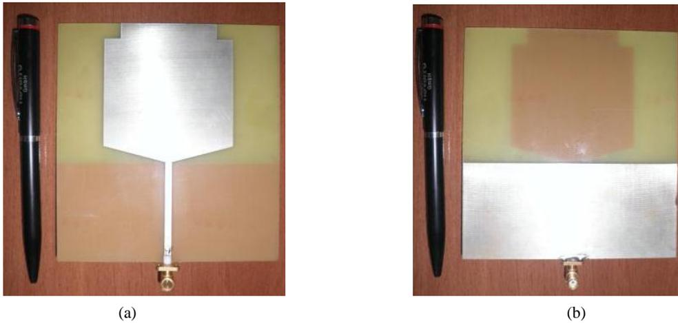
Figura 16. Antena física (a) vista frontal, (b) vista trasera.
