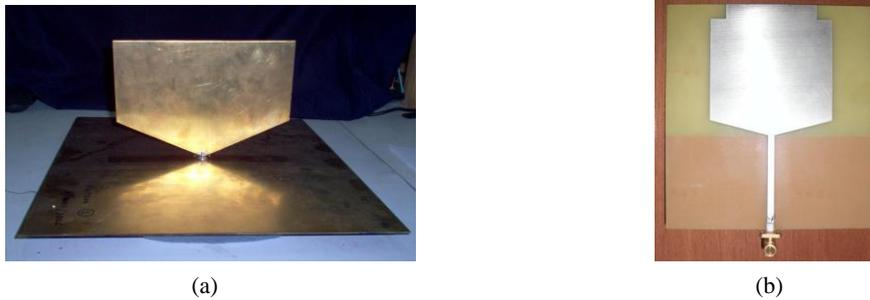
Figura 2. Antena monopolo (a) plano y (b) impreso.
