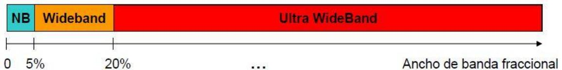
Figura 1. Ancho de banda fraccional para los sistemas de banda estrecha (NB), banda ancha (Wideband) y UWB.
