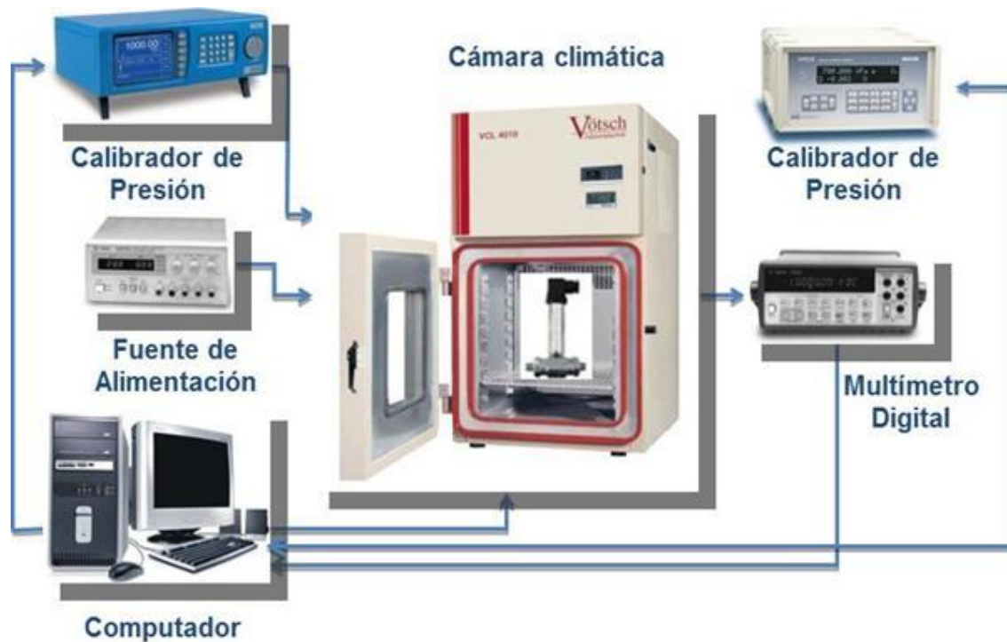
Figura 6: Sistema de calibración de los transmisores de presión
