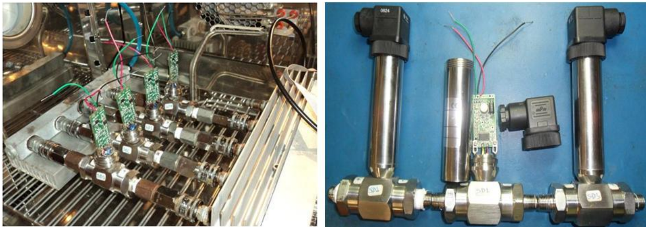
Figura 12: Transmisores de presión diferencial C&C
