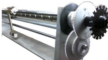
Figura 8. Disco rotatorio del encoder acoplado al eje de rotación del mareógrafo.
