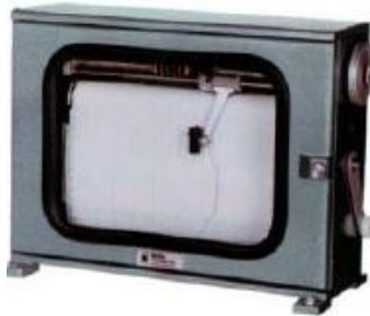
Figura 7. Mareógrafo de flotador y contrapeso SEBA Hydrometrie modelo Delta
