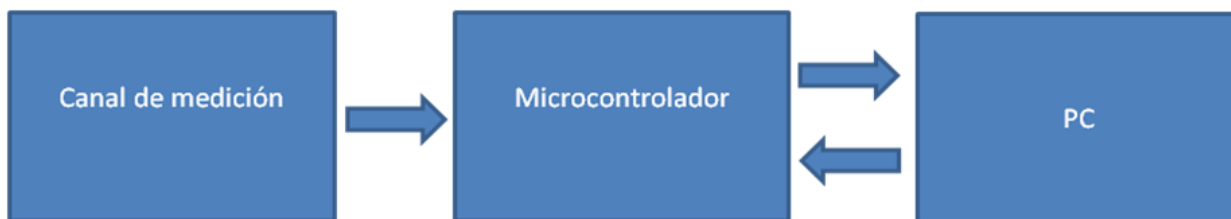
Figura 2. Diagrama de bloques general del sistema de adquisición de datos
