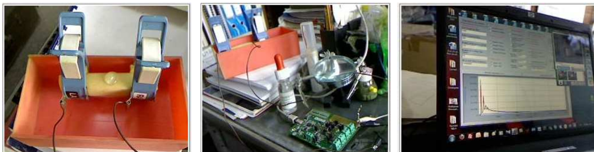
Figura 5. Simulación del sistema de retención/eliminación de líquido durante la hemodiálisis en los pacientes (Izq.: Phantom , Centro: KIT de medición: AD5933, Der.: Interfaz de medición en estación de trabajo: PC).
