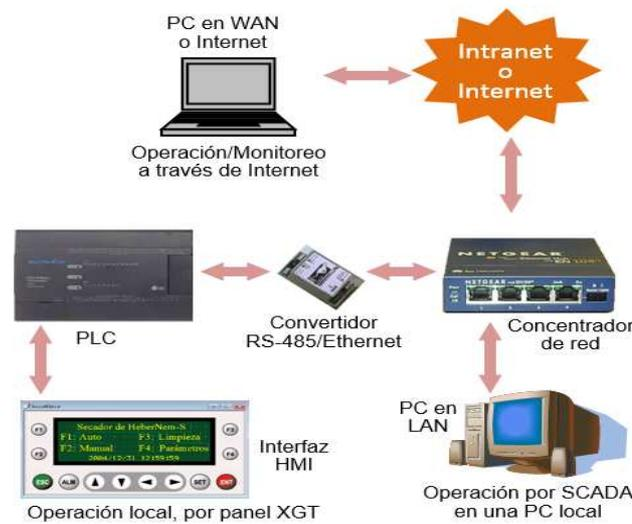
Figura 5. Conexión para operación local y/o remota
