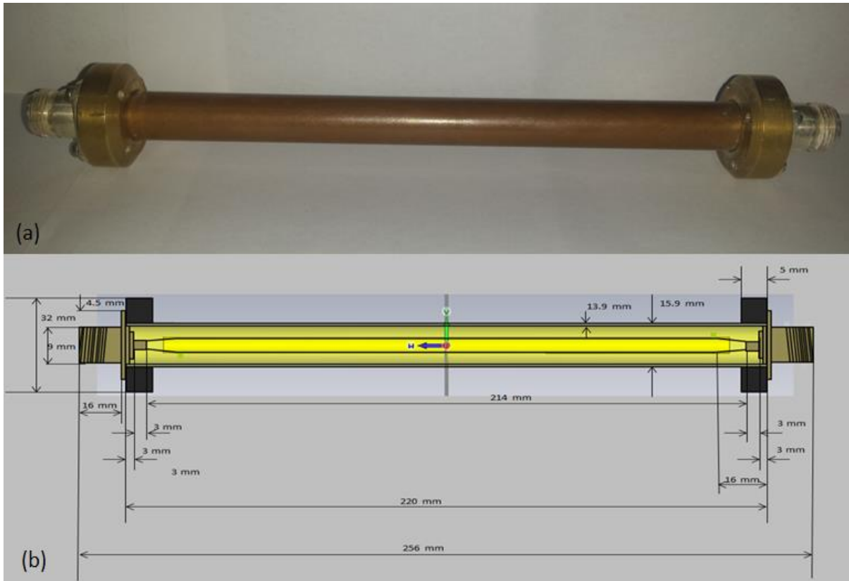
Figura 1 Línea de transmisión coaxial construida.
