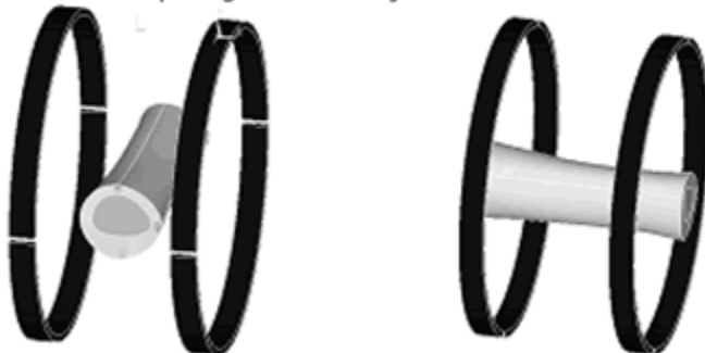
Figura 2. Modelo 3D de aplicación de campo magnético transversal y longitudinal al eje de las muestras.
