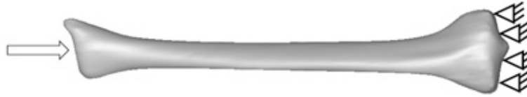
Fig. 2. Modelo de cargas aplicado a la tibia en 3D. Se define mediante una fuerza longitudinal de 500 N aplicada en la epífisis distal y las condiciones de borde se aplican en la epífisis proximal como un empotramiento.
