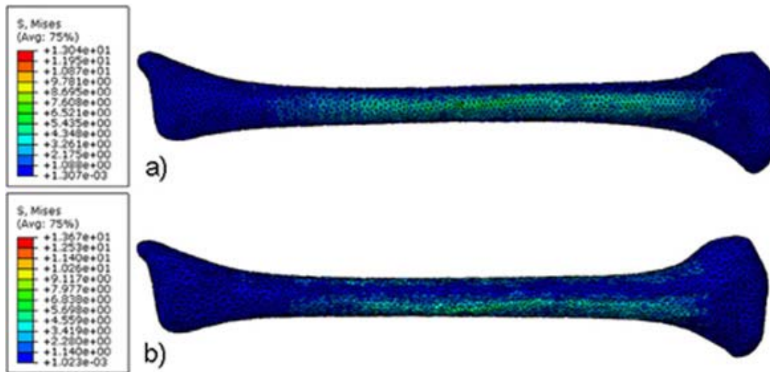
Fig. 5. Distribución de los esfuerzos en la tibia para propiedades mecánicas no homogéneas del modelo. a) C3D4 de 2,5 mm. b) C3D4 malla no estructurada.
