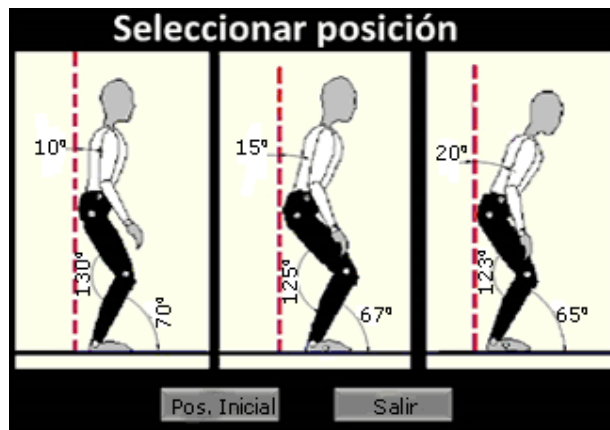
Fig. 10. Panel táctil con interfaz de usuario para controlar el dispositivo de órtesis.
