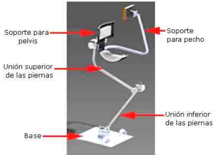
Fig. 2. Partes de la órtesis activa.
