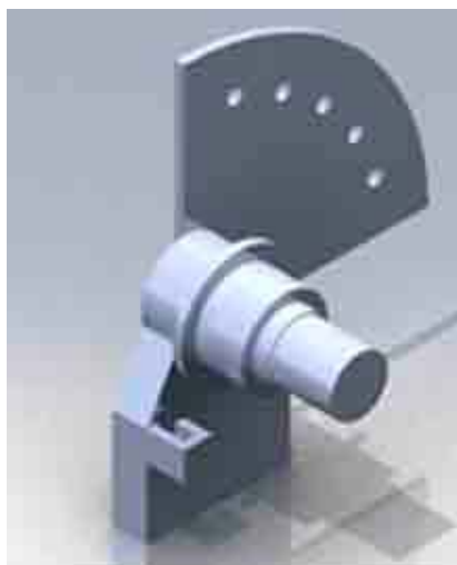
Fig. 5. Vista en perspectiva del eje de soporte para articulación inferior.
