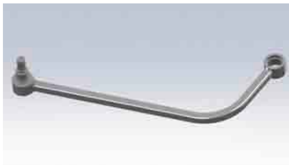
Fig. 7. Unión superior de las piernas.
