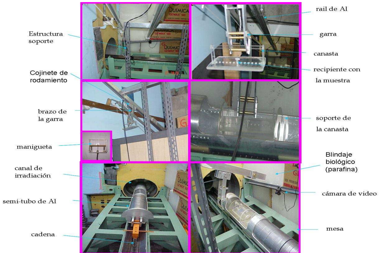
Figura 3. Vistas del dispositivo para el posicionamiento de las muestras biológicas con el reactor en operación.
