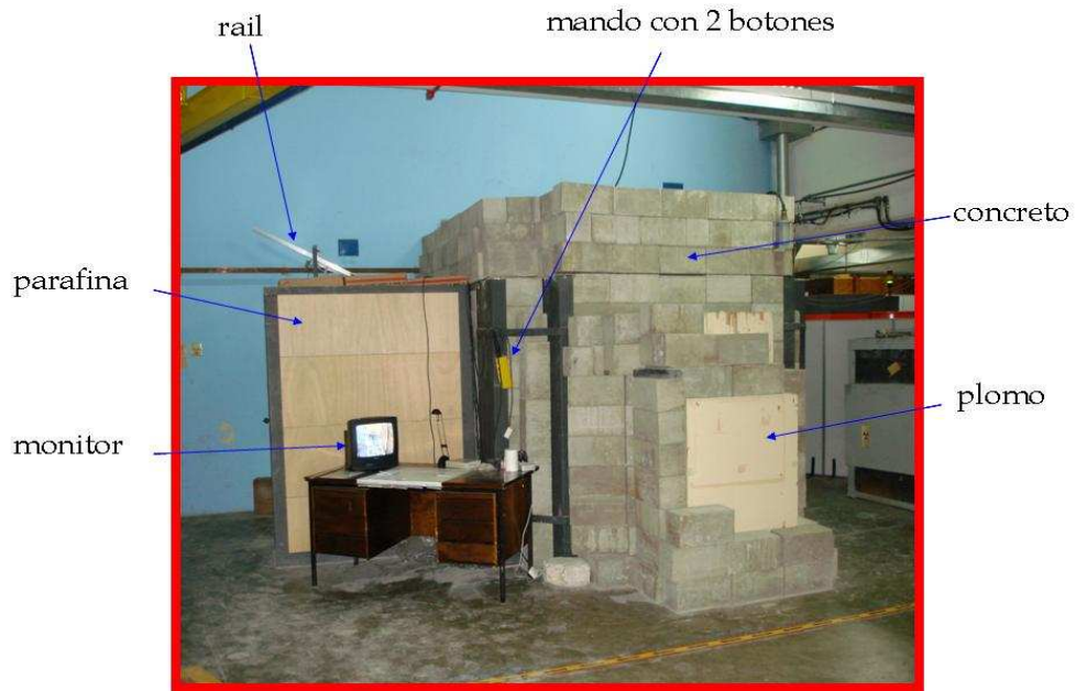
Figura 2. Vista real de la sala de experimentos con su blindaje.
