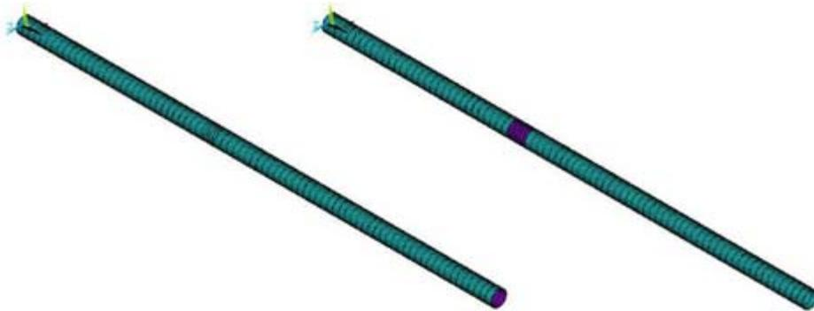
Figura 1. Modelos por EF del tubo sin y con grieta
