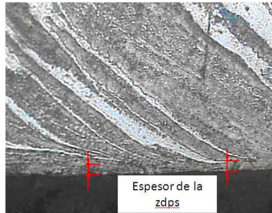
**Figura 5** Muestra 1. Se puede observar la deformación primaria y la secundaria. Señalado en rojo se encuentra el ezdps. Nital 2%, (400x).
