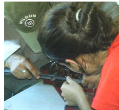
Foto 2. Alumnos realizando una medición de distancia entre ejes de ruedas dentadas
