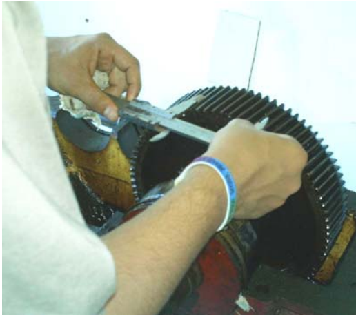
Foto 3. Alumno preparando el pie de rey para realizar medición de la tangente base de una rueda dentada
