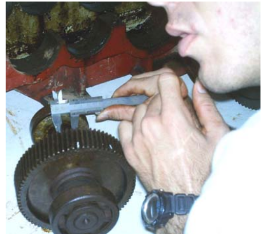
Foto 4. Alumno ejecutando medición de espesores de dientes
