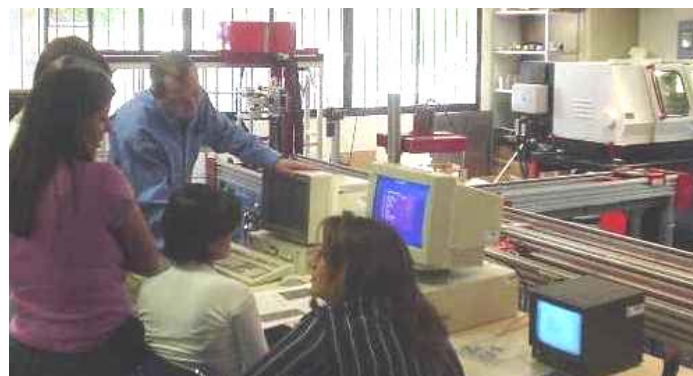
Foto 8. Profesor presentando a un equipo de alumnos el sistema AMNET ejecutado en la computadora central. Muestra parcial de la Celda de Manufactura donde fue desarrollada la experiencia. A la izquierda y fondo Robot AS/RS, a la derecha y extremo superior el Torno CNC. La pequeña pantalla encendida (derecha extremo inferior) corresponde al visor del sistema de inspección por visión
