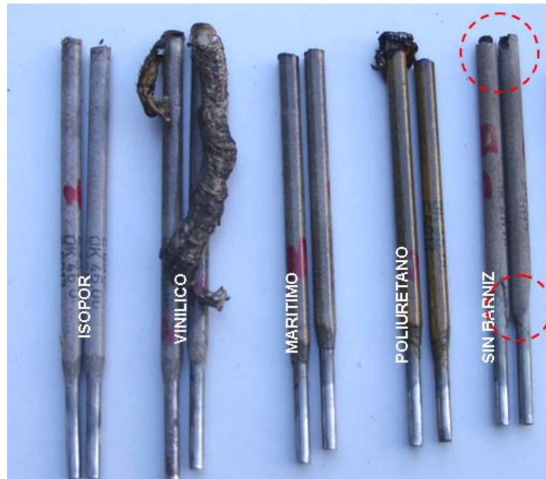
Fig. 2. Aspecto de los consumibles posterior a la soldadura (colillas)
