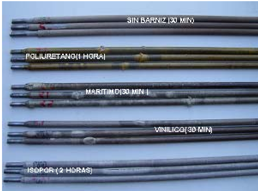
Fig. 6. Daños en el revestimiento posterior a la prueba de humectación
