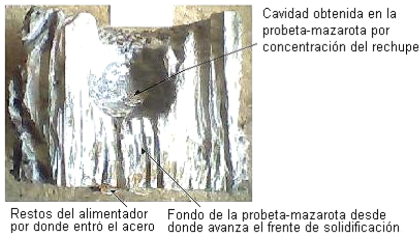
Fig. 3. Sección longitudinal de una probeta-mazarota. Tiempo de solidificación = 15 minutos, espesor de pared del casquillo = 47 mm y espesor de cobertura = 65 mm
