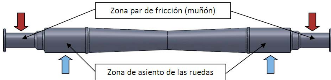
Fig. 1. Modelo de cargas empleado en el cálculo de la resistencia del eje del carro jaula
