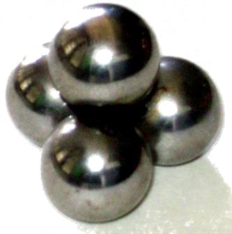
**Fig. 3.** Soldadura de las cuatro bolas para ensayo de extrema presión
