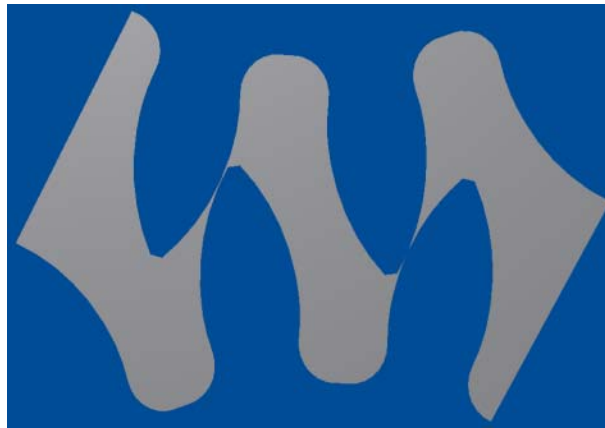
Fig. 5 Modelación del contacto entre los dientes de las coronas de molinos en el software INVENTOR 2011
