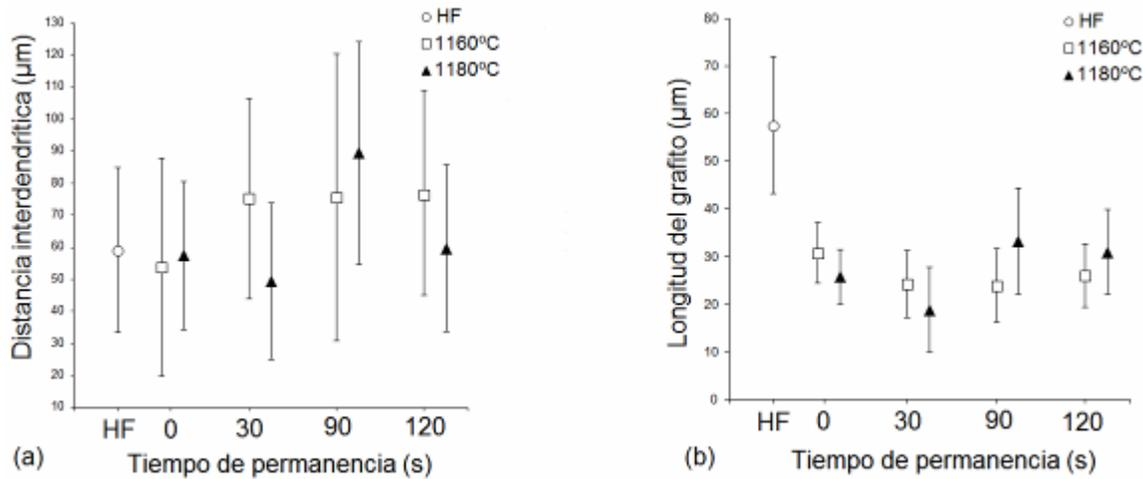
**Fig. 4.** Influencia del tiempo de permanencia y la temperatura en: (a) Distancia entre los brazos interdendríticos y (b) longitud del grafito
