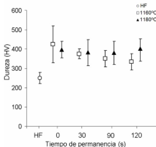
**Fig. 5.** Comportamiento de la dureza para el Hierro Fundido Fe-2.6 wt%C-1.5 wt%Si con tiempos de permanencia de 0, 30, 90 y 120s a temperaturas de 1160°C y 1180°C
