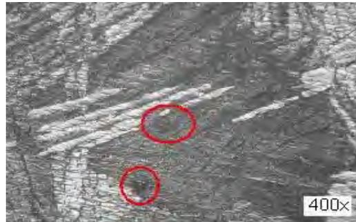
**Fig. 7.** Poros en la microestructura
