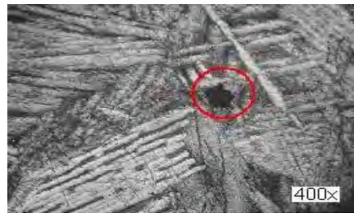
**Fig. 5.** Poros en la microestructura
