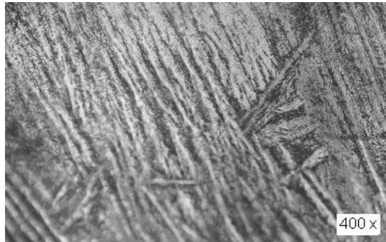
**Fig. 14.** Microestructura de la aleación de titanio después del proceso de soldadura.
