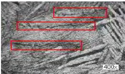
**Fig. 4.** Grietas en la microestructura
