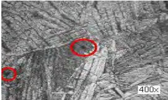
**Fig. 8.** Poros en la microestructura
