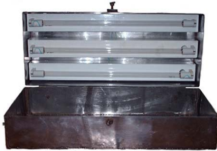
Fig. 2. Reactor UV de canal abierto
