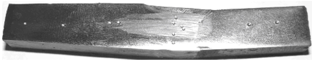
Fig. 4. Selección de puntos para el análisis de la dureza
