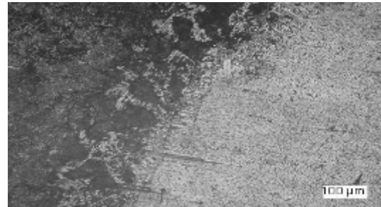
Fig 6b. Zona unión (Estructura tipo playa en la región de transición)
