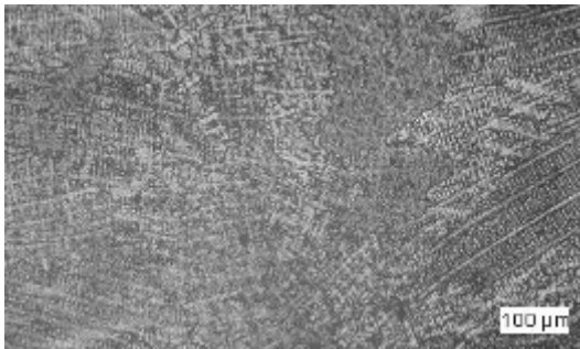
Fig. 5c. Estructura de ferrita con carburos dispersos
