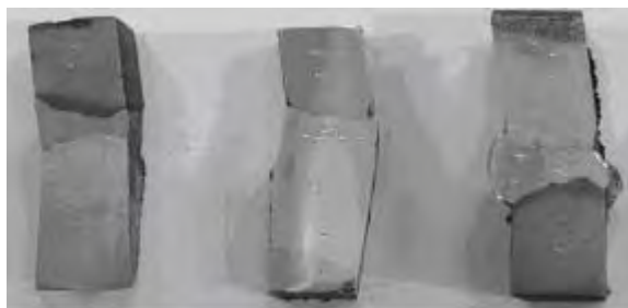
Fig. 1. Preparación metalográfica de las muestras soldadas
