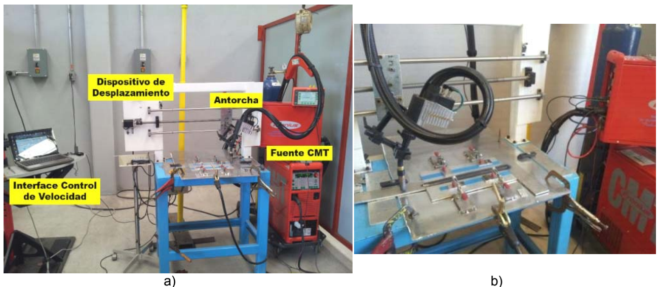
Fig. 1. Instalación para posicionar y sostener los cupones, así como para el desplazamiento regulado de la antorcha CMT
