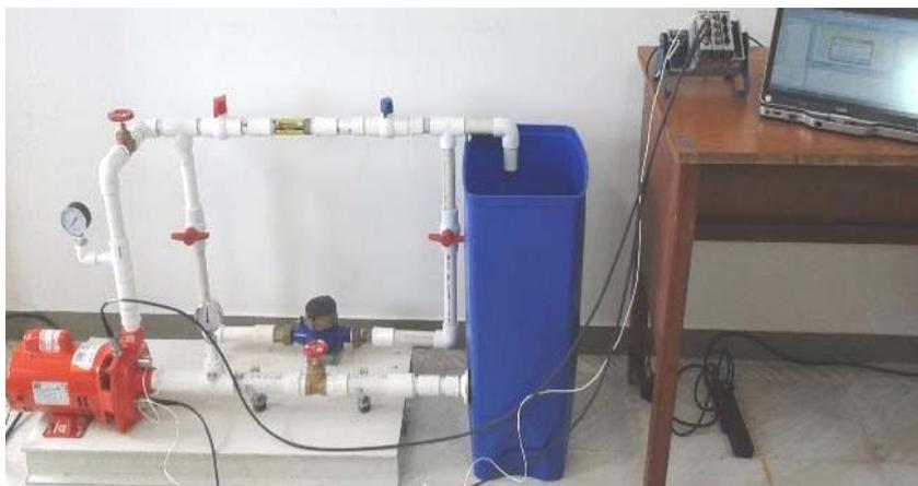
**Fig. 1.** Banco de pruebas experimental para simular el efecto de cavitación en una bomba centrífuga monoblock
