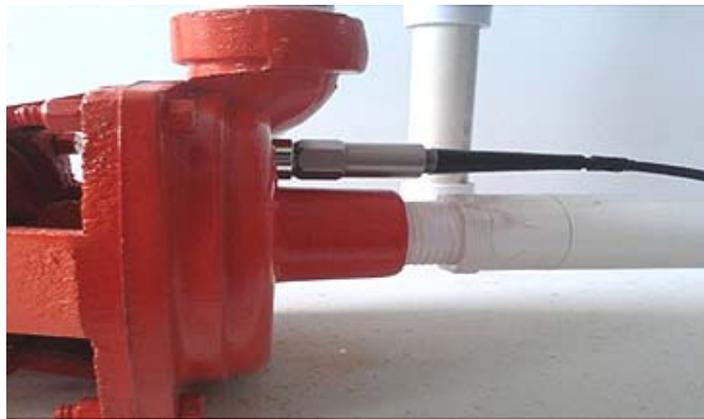
Fig. 3. Acelerómetro ubicado en posición axial al rodete de la bomba centrífuga
