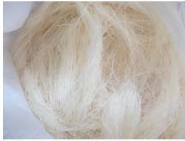
Fig. 2. Fibras utilizadas como refuerzo de los compuestos fabricados
