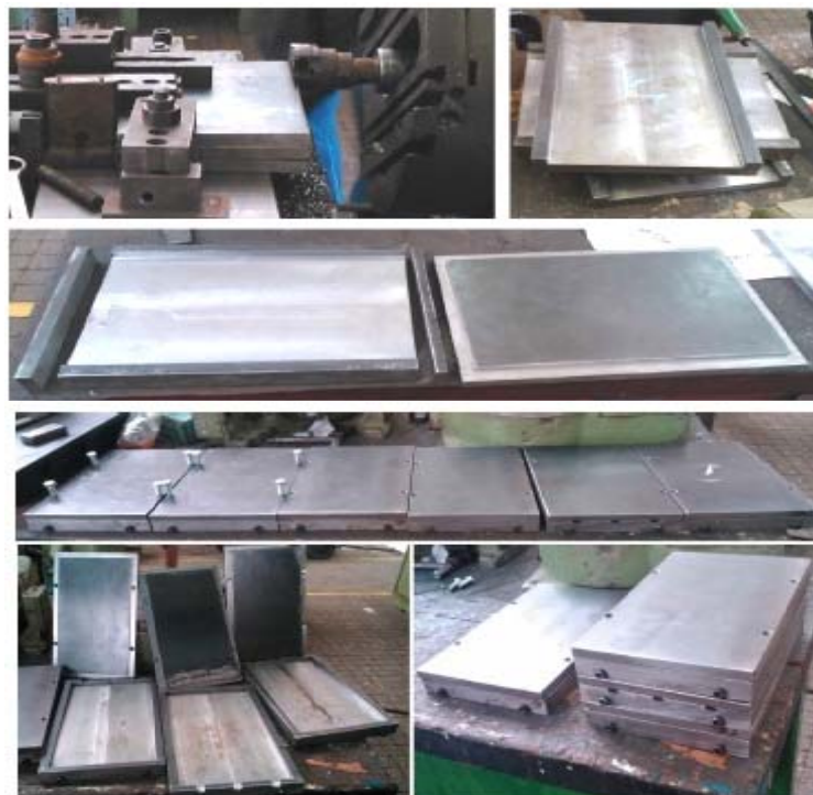
Fig. 5. Fabricación de los moldes tipo caja de acero AISI1020
