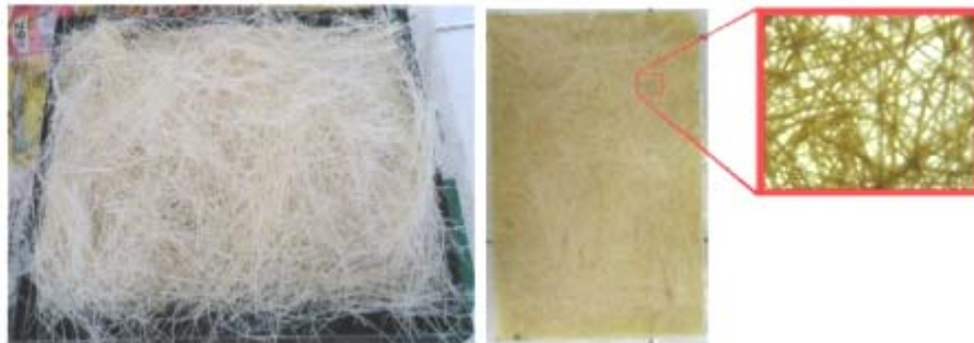
Fig. 6. Distribución aleatoria de las fibras largas colocadas como refuerzo en los compuestos y placa con bajo porcentaje de inclusión de fibra 10%
