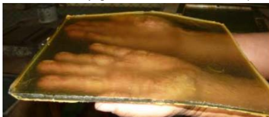
Fig. 1. Placa de solo resina y catalizador utilizado como matriz
