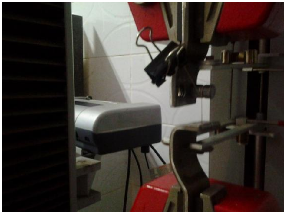
Fig. 5. Dispositivo para el ensayo de desprendimiento de la fibra a tracción colocado en las mordazas de la máquina universal.
