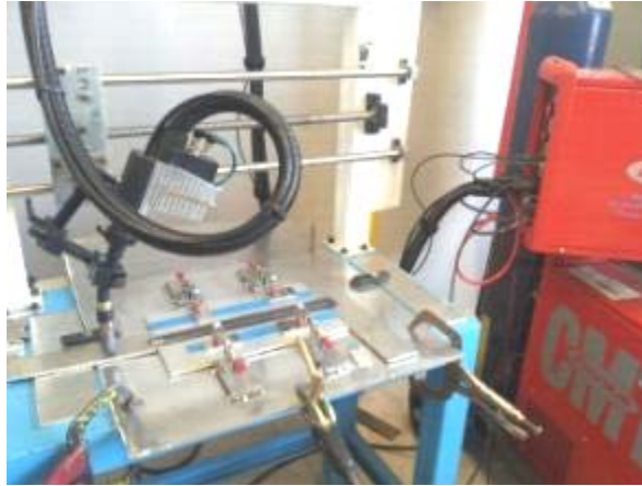
Fig. 1. Instalación para el desplazamiento regulado de la antorcha CMT, diseñada y fabricada por el autor (CIDTS)
