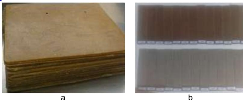
**Fig. 1.** (a) Placas de material compuesto. (b) Láminas obtenidas de las placas para hacer los ensayos
