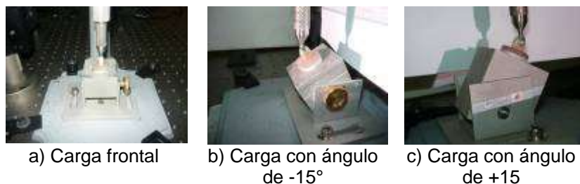
Fig. 5. Aplicación de cargas a las muestras
