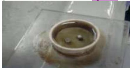
**Fig. 2.** Probeta para ensayo metalográfico
