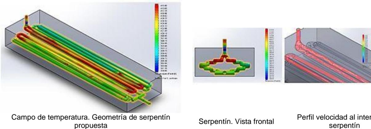
**Fig. 4.** Perfil de temperatura en el serpentín (temperaturas en K)
