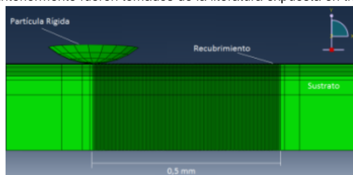
Fig. 1. Modelo de simulación del rayado de una partícula rígida sobre un sistema recubierto
