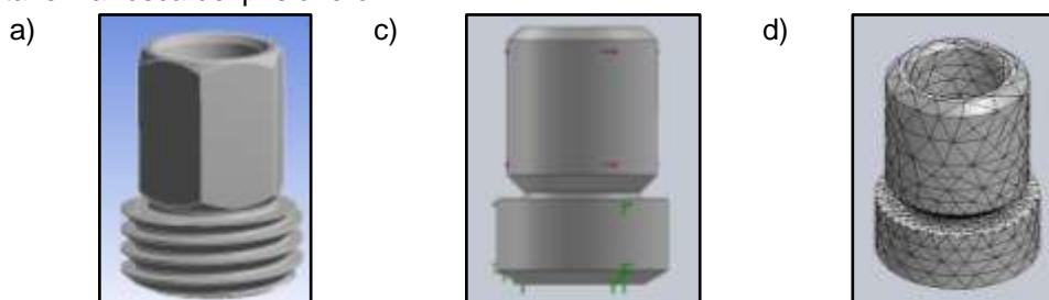
Fig. 2. a) Modelo CAD 3D, b) Condiciones de borde c) Mallado
